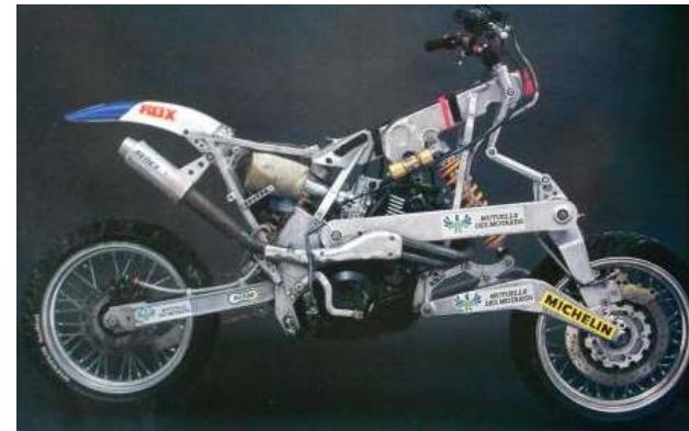
2WD (前後輪駆動) サバール 2 1 年前の別冊モーターサイクリストより
